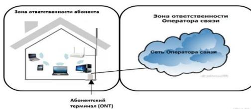
**СХЕМА ВКЛЮЧЕНИЯ ПОЛЬЗОВАТЕЛЬСКОГО (ОКОНЕЧНОГО) ОБОРУДОВАНИЯ ПО**
